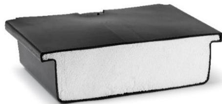
Tous nos flotteurs sont proposés en version « **moussée** ». Les flotteurs sont remplis de billes *polystyrène expansées* formant un bloc d'une cohésion maximale. D'une grande fiabilité ce procédé nous permet de garantir l'insubmersibilité des flotteurs même en cas de déchirement de l'enveloppe plastique.
